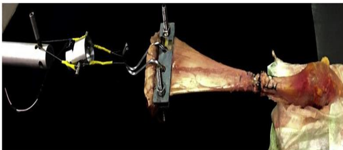
Figure 71 : photo d'une machine utilisée pour mesurer la force de traction du tendon(34)
