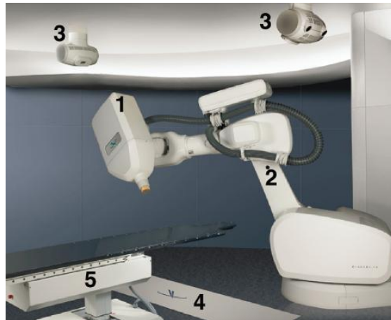
Figure 114: Cyberknife (LINAC) monté sur un bras robotisé[254]
