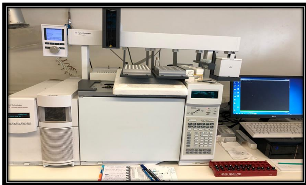
Figure 33 : Chromatographie en phase gazeuse 6890 à détecteur de masse, GC-MS (Agilent®)
