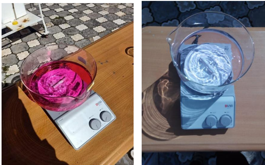
Figure V.6 : Dégradation du Rhodamine B par la photolyse (RS/ \text{H}_2\text{O}_2 ) (état initiale et finale).
