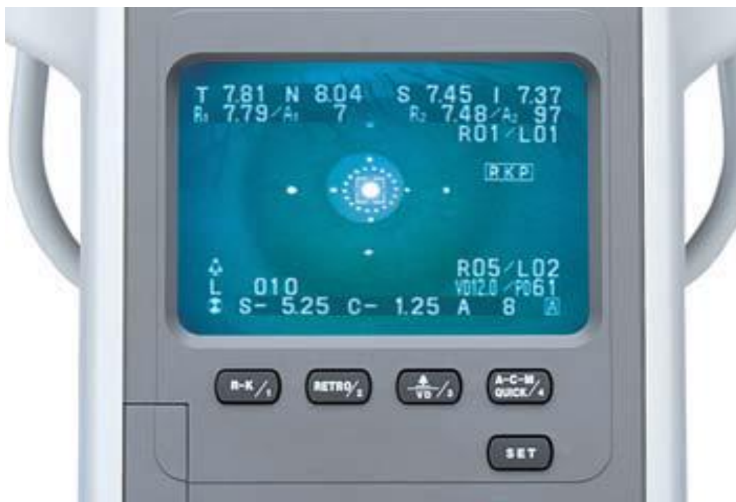
Figure 37 : le Speedy-K (Luneau technology) qui un refracto-keratomètre automatisé (service d'ophtalmologie de l'hôpital militaire de Constantine)
