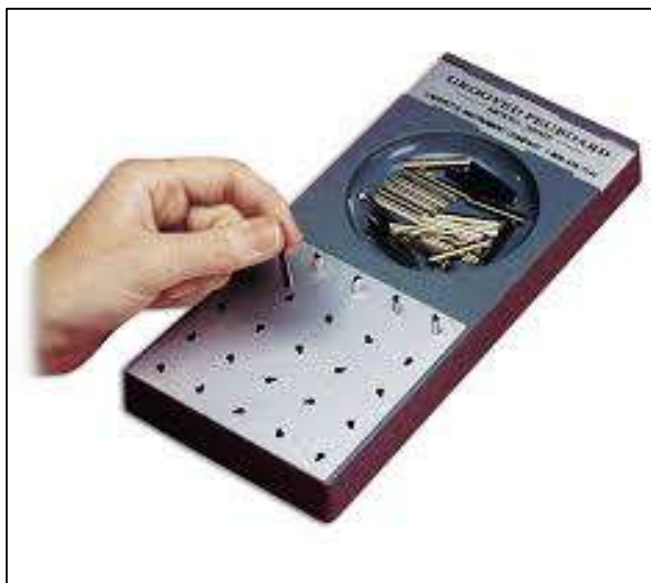
Fig. 37 : Grooved pegboard test. Il est conseillé au patient de placer les 25 tiges le plus rapidement possible de gauche à droite en utilisant uniquement la main dominante. Le temps est mesuré.
