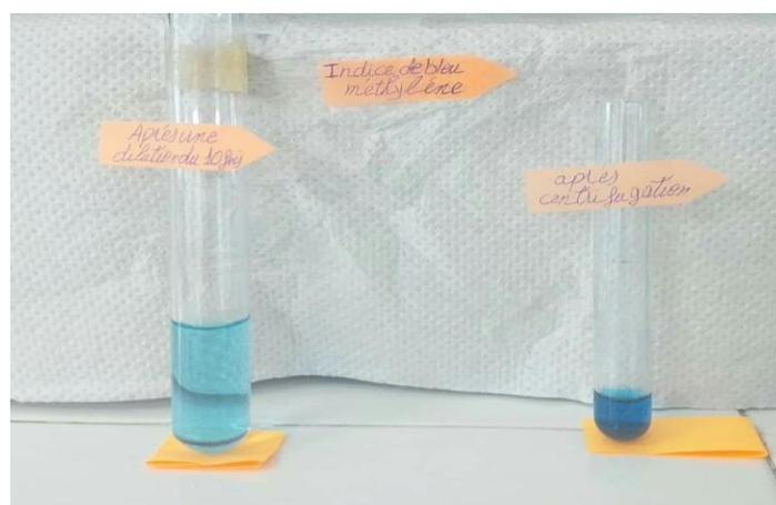
**Figure V- 7:** Détermination d’indice de bleu méthylène
