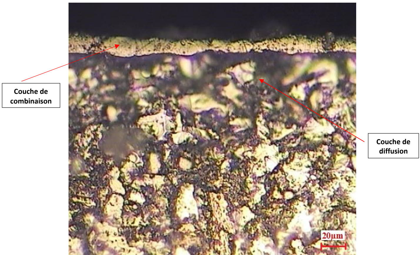
Figure IV. 5. Coupe transversale de l'acier C22 nitruré à 580°C pendant 12 h.
