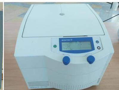
**Figure 2.11** : Centrifugeuse
