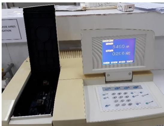
Figure 4.11 : spectrophotomètre
