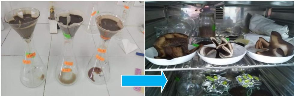
**Figure 4.9** : Différentes étapes pour la déterminer des MES.
