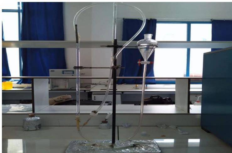
**Figure 4.14** : Dispositif pour mesurer le biogaz.
