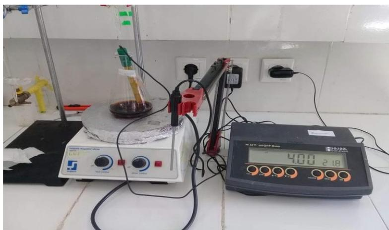
**Figure 4.10 :** Appareillage de mesure de TA et TAC.
