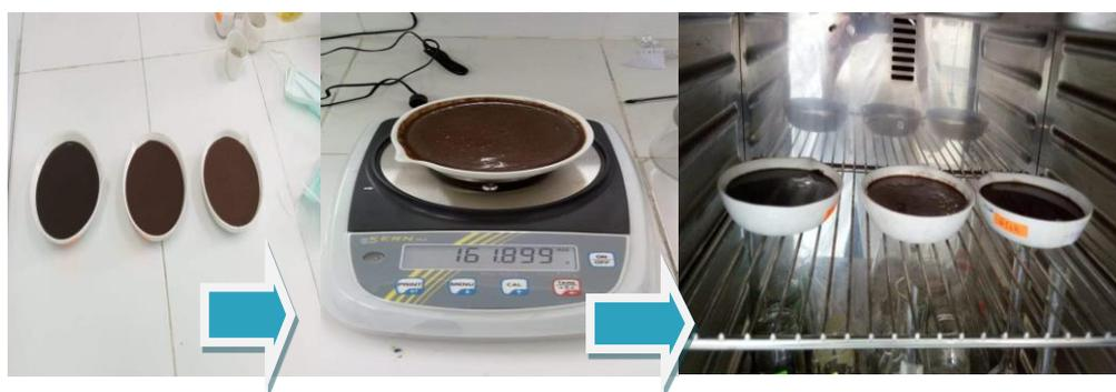
**Figure 4.6 :** Différentes étapes pour la détermination des TS.
