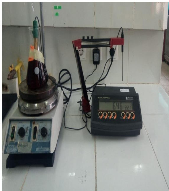
Figure III. 7 : Appareillage de mesure de TA et TAC
