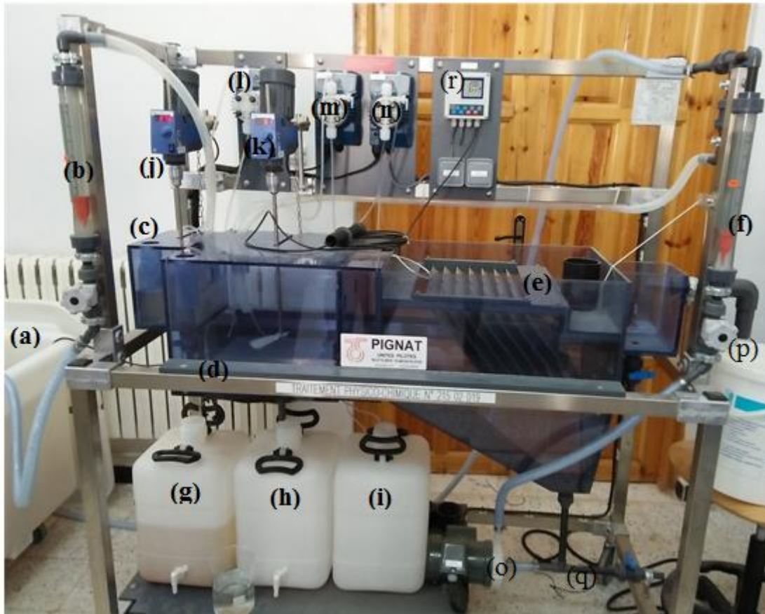
Figure 4.9 : Pilote de coagulation -floculation -décantation (Modèle : PIGNAT,TPC/3000, code : N° 215 02 019,France))
