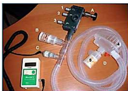
Fig. 2: Dispositif de CPAP à haut débit. A: manodétendeur-générateur de débit ( \geq 100 L/min; FiO_2 réglable = 35-100 %), doit être branché sur de l'oxygène médical pressurisé à 3,6-3,8 bars; B: valve de sécurité (20 cm H_2O , afin d'éviter les surpressions); C: monitoring de la fraction inspirée en oxygène ( FiO_2 ; optionnel); D: circuit de CPAP prémonté, à usage unique (masque, valve et circuit). 1: ON/OFF; 2: réglage du débit (idéalement maximal dans tous les cas, sauf volonté d'économie de gaz à FiO_2 100 %); 3: réglage de la FiO_2 (entre 35 et 100 %; en fait seulement deux paliers réellement utilisables, d'où le caractère optionnel du monitoring de FiO_2 ); 4: masque à patient unique, à jupe en silicone; nécessite un hamais de fixation; 5: valve de contrainte à ressort, permettant l'administration de la pression positive (différentes valves de niveau fixe sont disponibles; en routine 7,5 cm H_2O ). Plusieurs dispositifs et circuits sont actuellement disponibles chez différents distributeurs, avec des caractéristiques et un coût plus ou moins identique.
