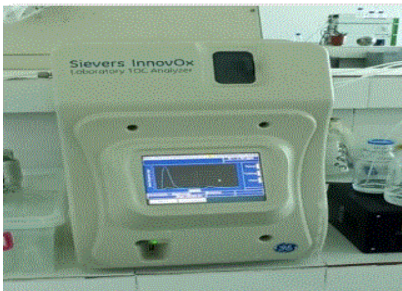
Figure 2.3 : Photo du COT mètre Sievers innovOX .
