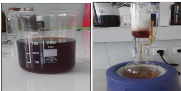
**Figure 4.4:** Extraction par Soxhlet.
