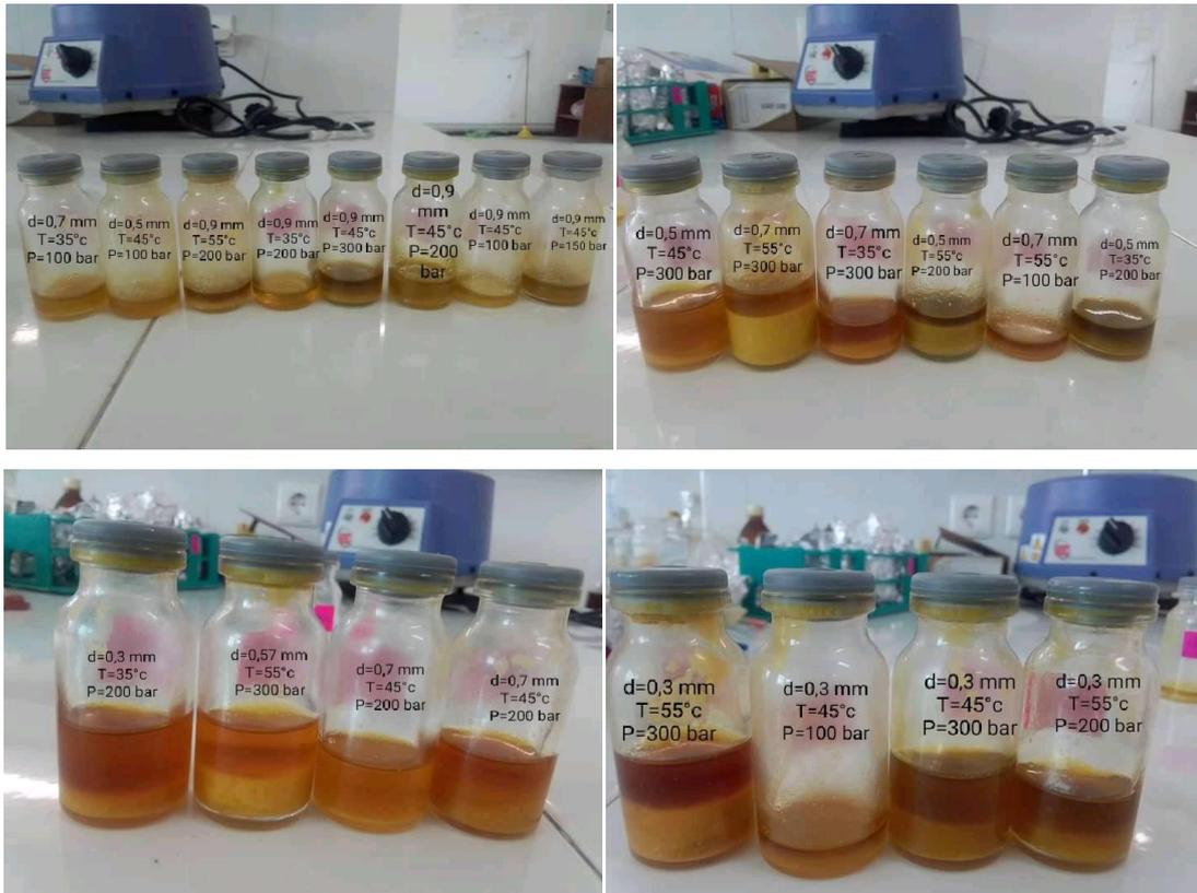
**Figure 5.1:** Différents extraits de graines de *Peganum harmala* par CO<sub>2</sub> supercritique dans différentes conditions.
