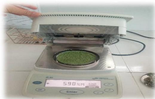
**Figure 4.6:** Dessiccateur infrarouge (Hygrometer (Denver instrument)).
