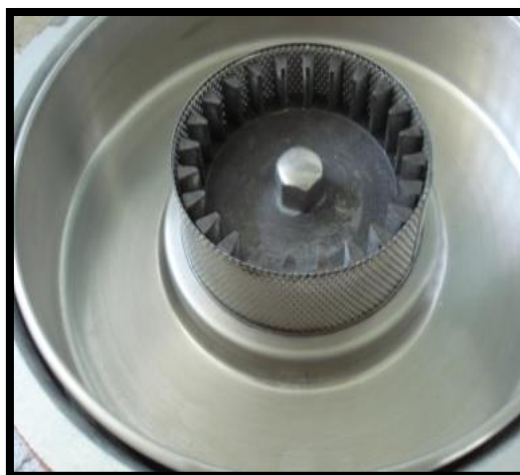
Figure IV.4 : Accessoires de la pulvérisette 14 « chambre de broyage ». (35)
