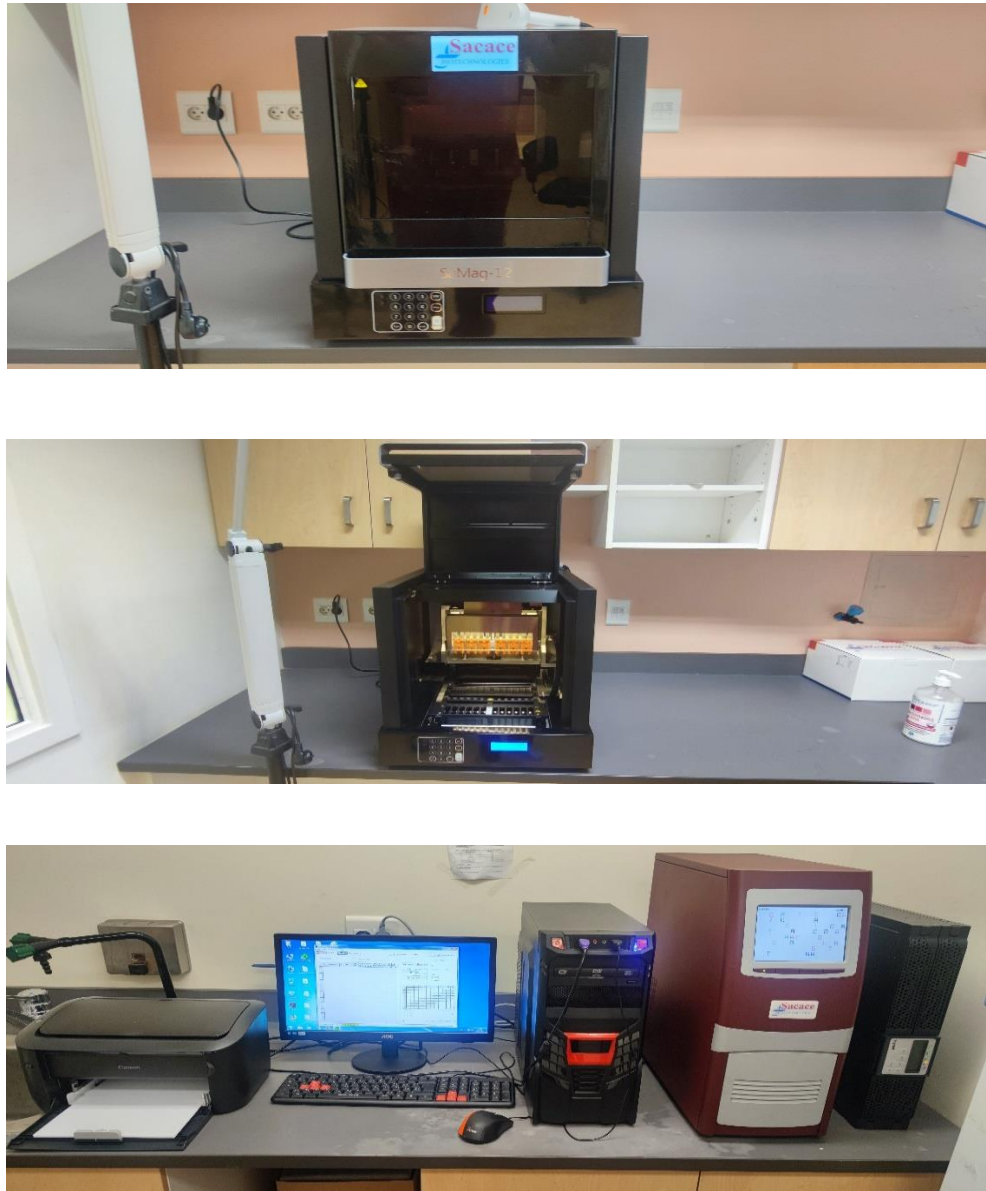
Figure 15. Automate de biologie moléculaire RT-PCR Sacace™ SaMag-12 (photos prises dans notre service) : A : Extracteur Sacace SaMag-12 fermé. B : Extracteur Sacace SaMag-12 prêt à l'emploi. C : Thermocycleur Sacace SaCycler-96 Real Time PCR System, avec son logiciel.
