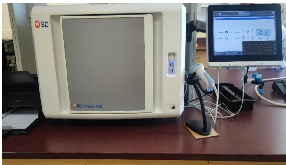
Figure 14. Automate d'identification des bactéries et de recherche des résistances aux antibiotiques, par la réalisation des CMI en milieux liquides ; le Becton Dickinson (BD) Phoenix M50 (photo prise dans notre service).
