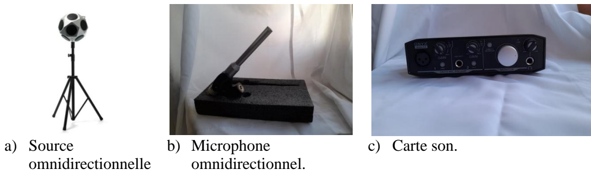
Figure 5.2. Equipements pour les mesures in-situ. (source : Auteur, 2023)
