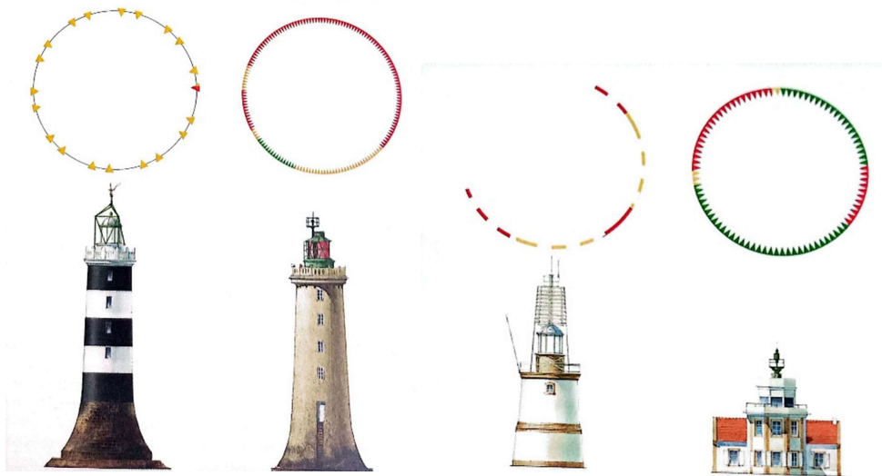
Figure 3.5. Distinction des phares par leur caractéristiques : hauteur, scintillements et usage de la couleur, de gauche à droite : phare de l'Aiguillon (22.50m), phare de la pointe de St Gildas (13.45m), phare de la Banche (30.30m), phare du Grand Charpentier (27.60m). Source : Arzur & Héron, 2015.
