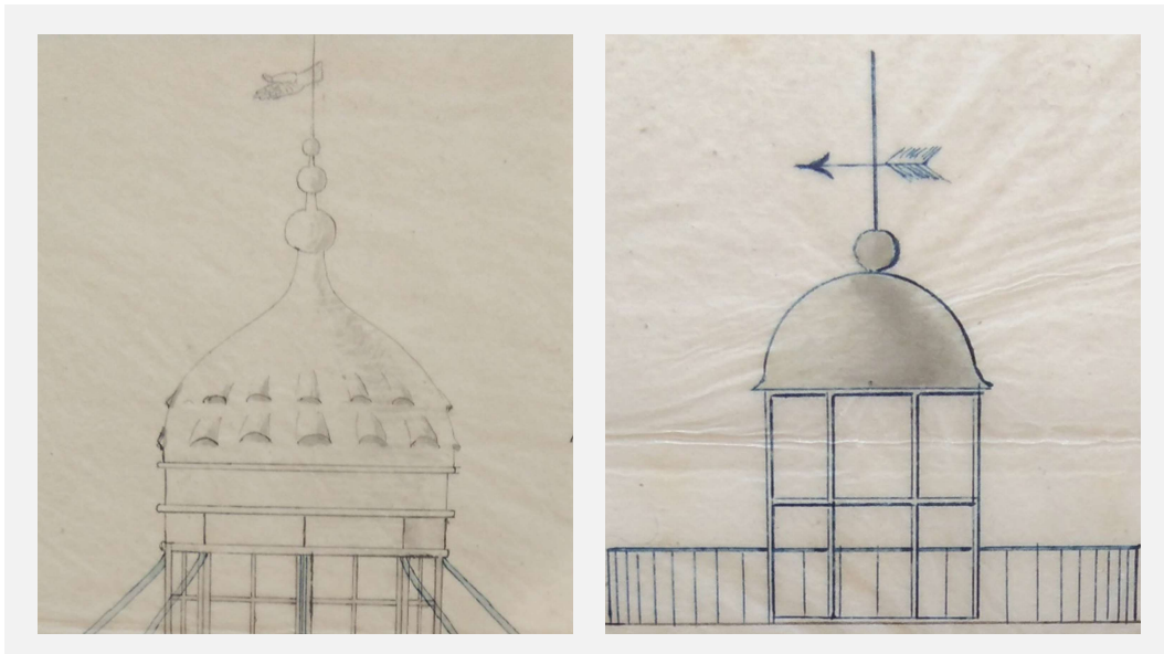
Figure 7.32. Types de coupoles retrouvées dans les phares algériens. Source : Archives Nationales de France, Traité par auteur.
