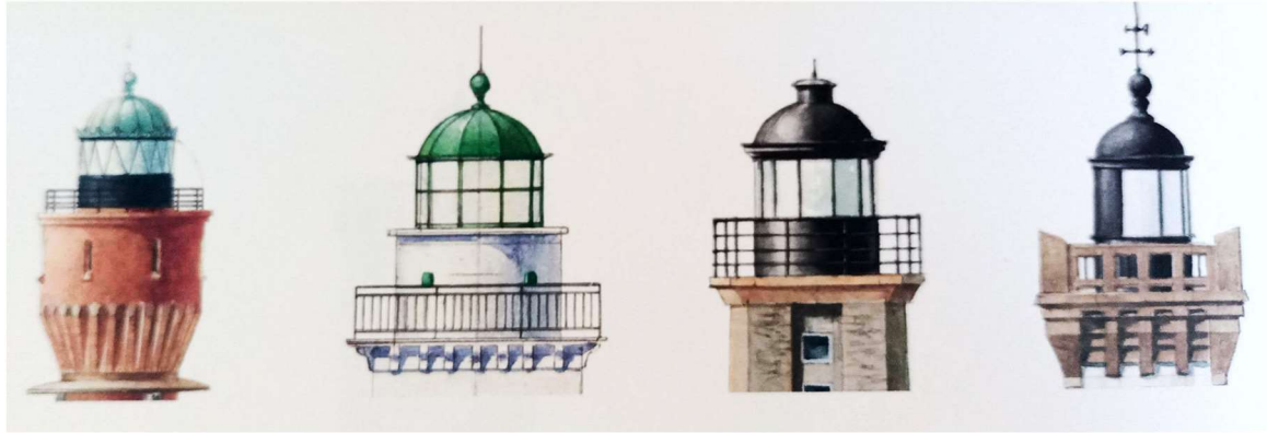
Figure 3.9. Différents exemples de lanternes. Source : Arzur & Héron, 2015.
