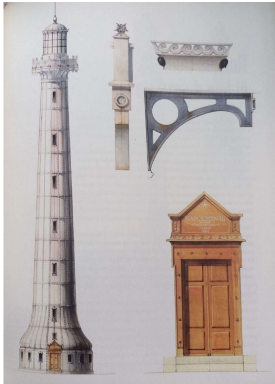
Figure 2.13. Le phare d'Amédée, charpente et détails. Source : Arzur & Héron, 2015.
