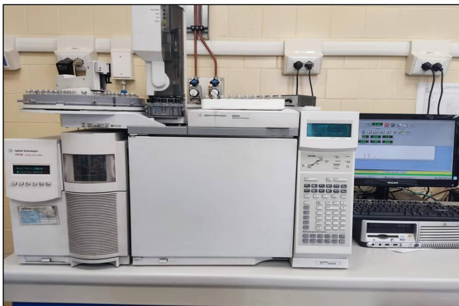
**Figure 22. Chromatographe en phase gazeuse AGILENT Technologies 6890N.**
