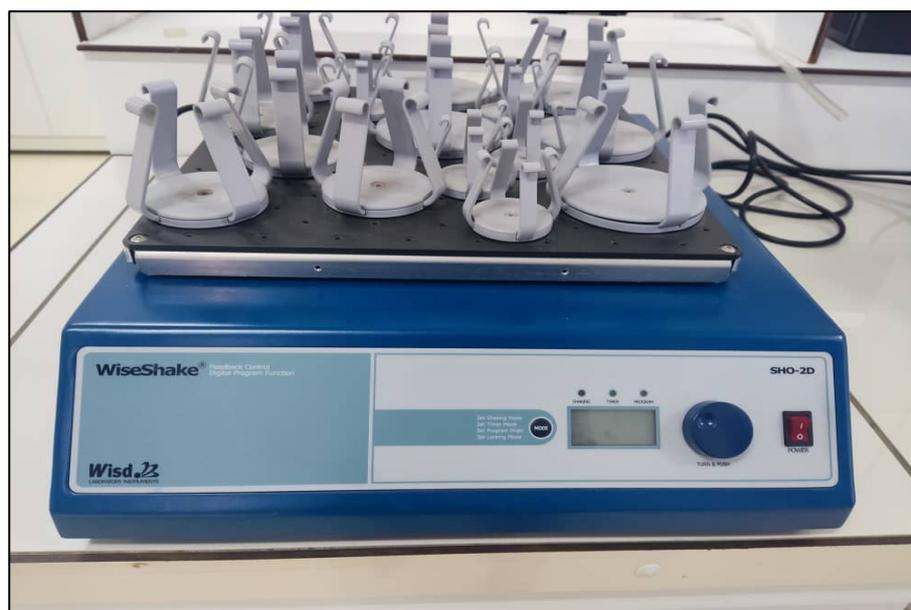
**Figure 29. Agitateurs (extracteurs) : Wise Shake®.**
