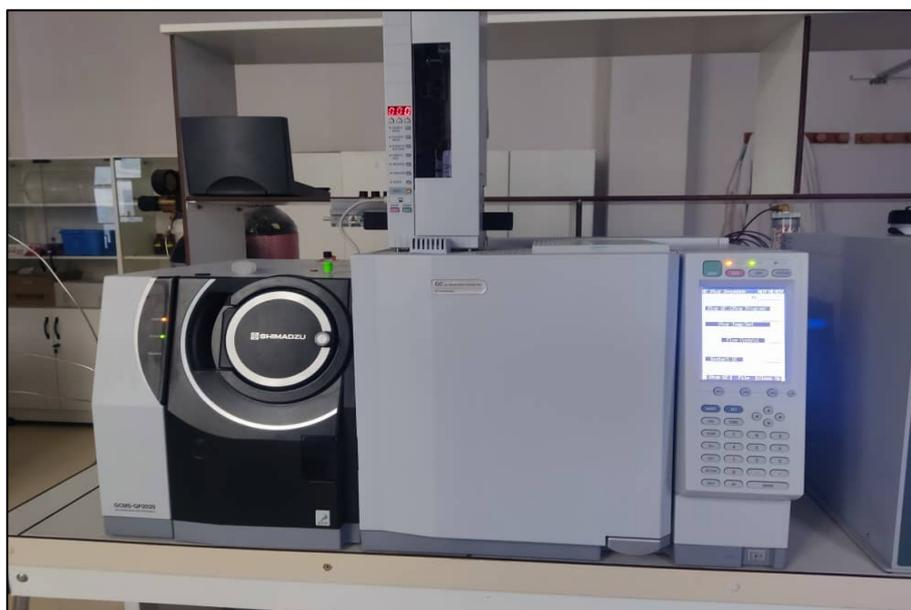
**Figure 20. Chromatographe en phase gazeuse GC-2010 Plus SHIMADZU.**
