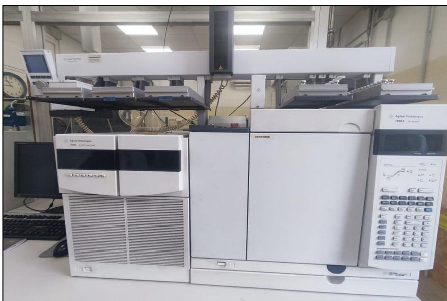
**Figure 23. Chromatographe en phase gazeuse AGILENT Technologies 7890B.**
