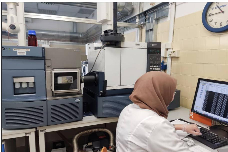
**Figure 24. Chromatographe en phase gazeuse AGILENT 7880A.**
