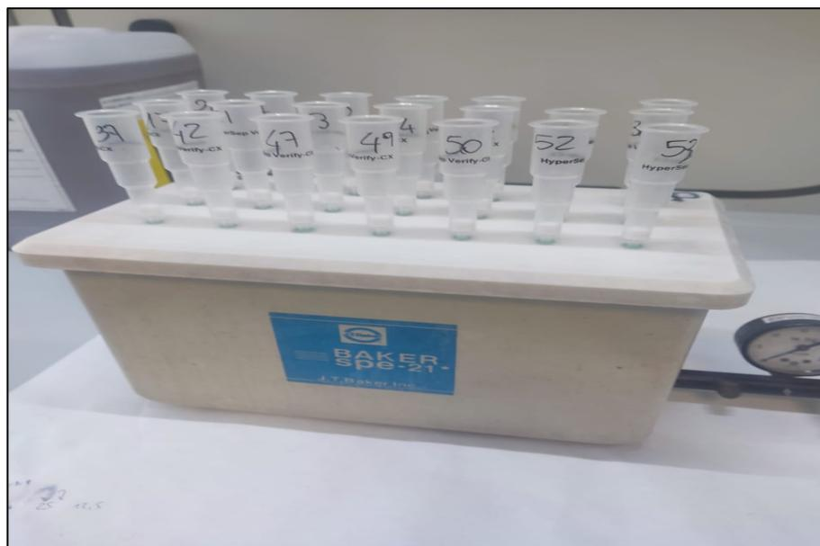
**Figure 28. Système d'extraction SPE BAKER-21®.**
