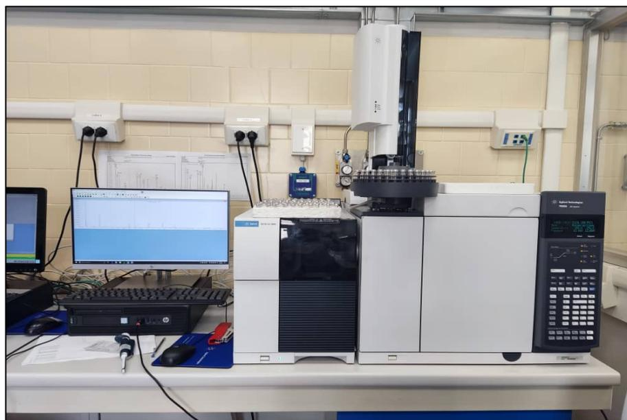
**Figure 21. Chromatographe en phase gazeuse AGILENT Technologies 7890B.**
