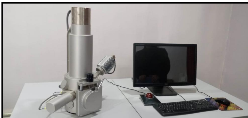
Figure 3.7 : Microscope électronique à balayage (MEB)
