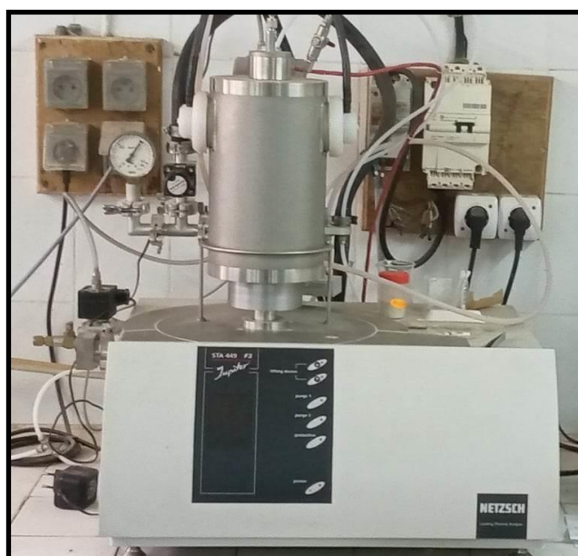
Figure 3.5 : Appareil thermogravimétrique STA449 F3 Jupiter (ATG)
