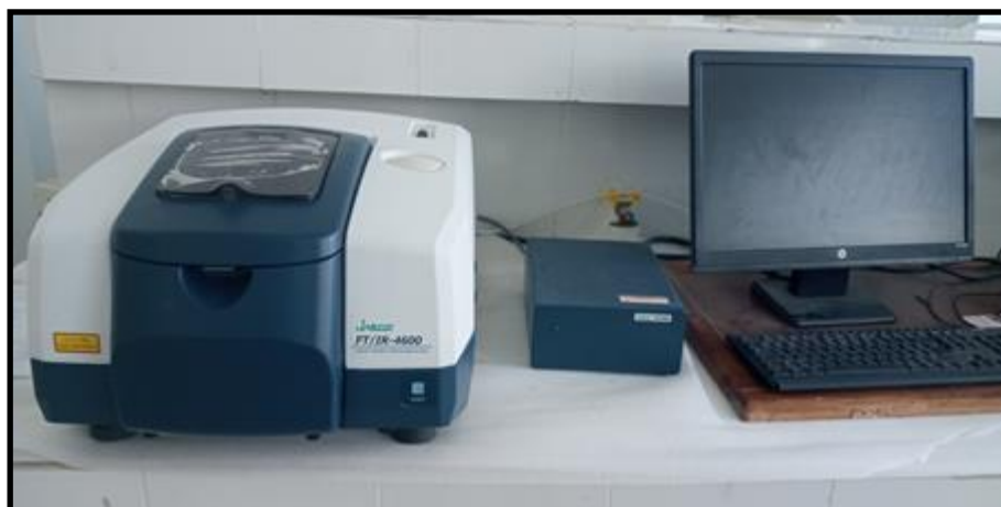
Figure 3.6 : Appareil Spectroscopie infrarouge JASCO FT/IR-4600
