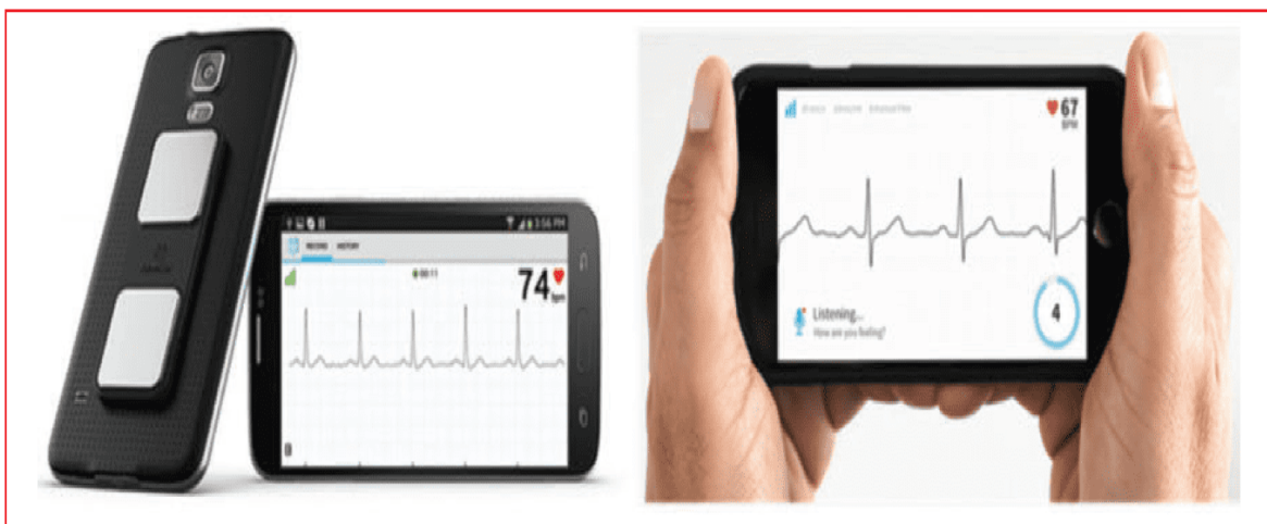
Figure 25 : Système AliveCor Kardia® développé par la firme américaine AliveCor. Le système AliveCor Kardia® est constitué d'un petit dispositif de capture d'ECG à 1 dérivation à partir des doigts, connecté à une application pour Smartphone permettant d'enregistrer 30 secondes d'ECG (iECG).
