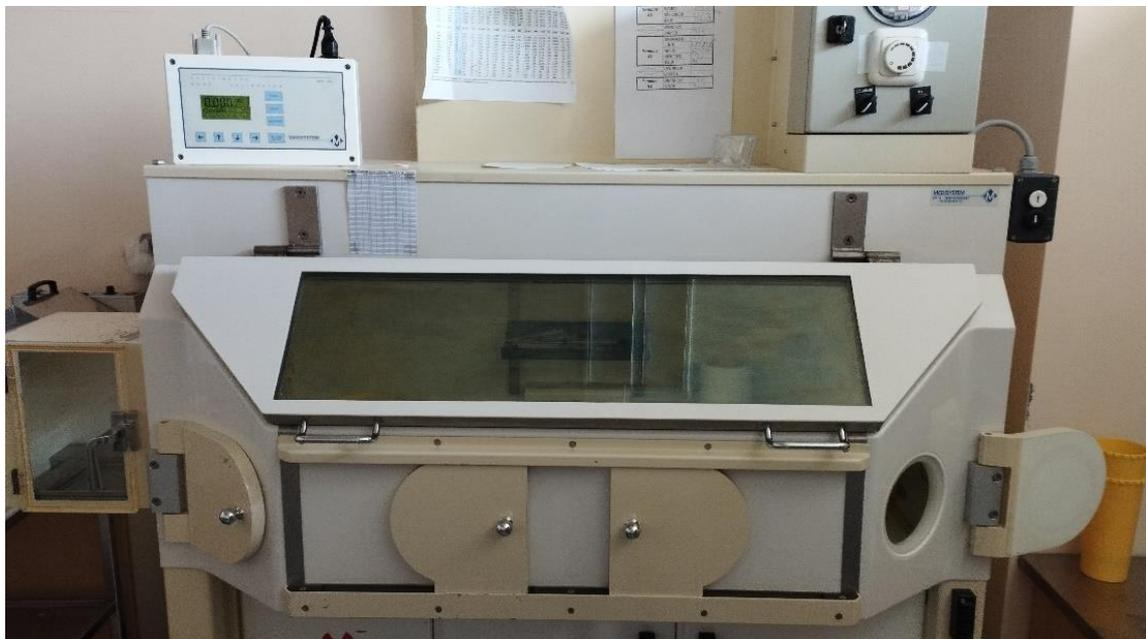
*Figure 20: Hotte plombée et activimètre du service de médecine nucléaire HMRUC, utilisés pour la préparation des radiopharmaceutiques*
