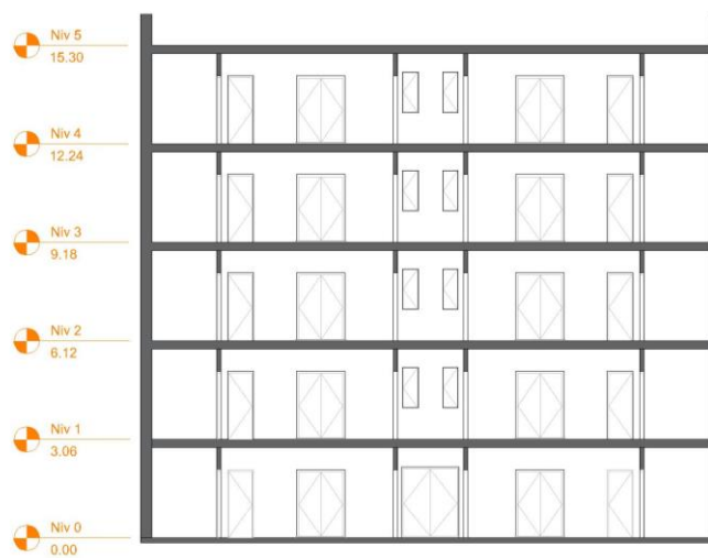
(d) Coupe longitudinale du bâtiment
