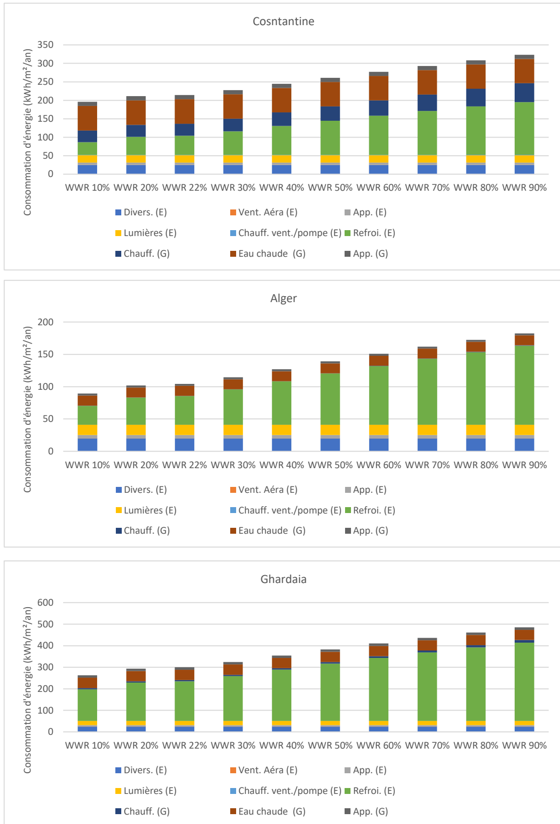
Figure 5.20 Effets des variations du WWR sur les résultats de consommation finale d'énergie (Appartement 03)
