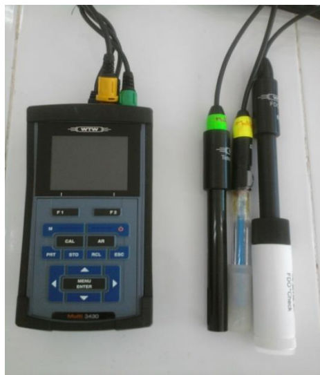
Figure III.05 : Un Multi-paramètres, Oxi-multi 3430 de WTW utilisé pour les mesures directes de certains paramètres.
