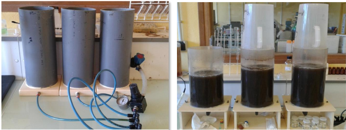
Figure VI.02 : Photographie des montages utilisés pendant tests de biodégradation en batch.
