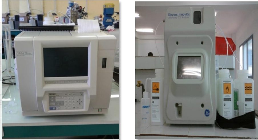
Figure III.02 : Analyseur COT Sievers InnovOx–Firmware et TOC-V CSH/CSN de SHIMADZU utilisé pour la mesure de COT .
