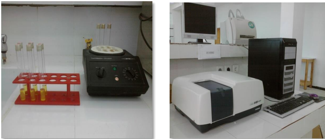
Figure III.01 : Photographie du bloc de digestion et l'UV-Visible JASCO V-630 utilisés pour la mesure de DCO.
