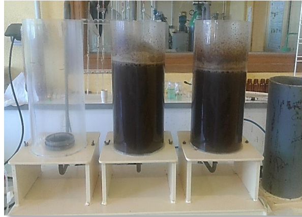
Figure IV.03 : Etape de mise à l'endogène avant les tests respirométriques de type LSS
