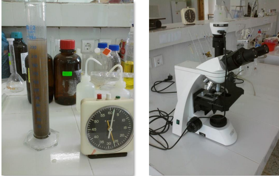
Figure III.04 : Moyen de mesure de l'indice de boues et photographie d'un microscope OPTECH Technology-Infinity utilisé pour la visualisation des floccs bactériens.
