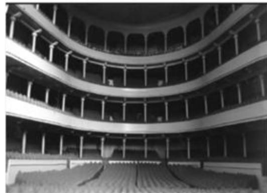
Maquette de la salle de la Philadelphia Academy of Music réalisée à l'échelle 1/25 e en aggloméré de haute densité. Les sièges ont été modélisés avec de la mousse absorbante. (Source Cruz Barney, F )
