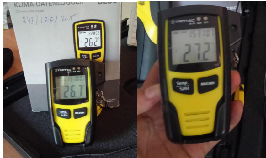
Figure 6.28 L'enregistreur de données de température et d'humidité. (Source du Laboratoire EE)
