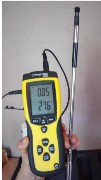
Figure 6.30 Anémomètre thermique TA 300. (Source du Laboratoire EE)
