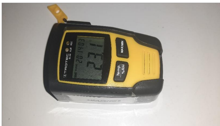
Figure 4.32 : Enregistreur de données climatiques, TROTEC, BL30.
