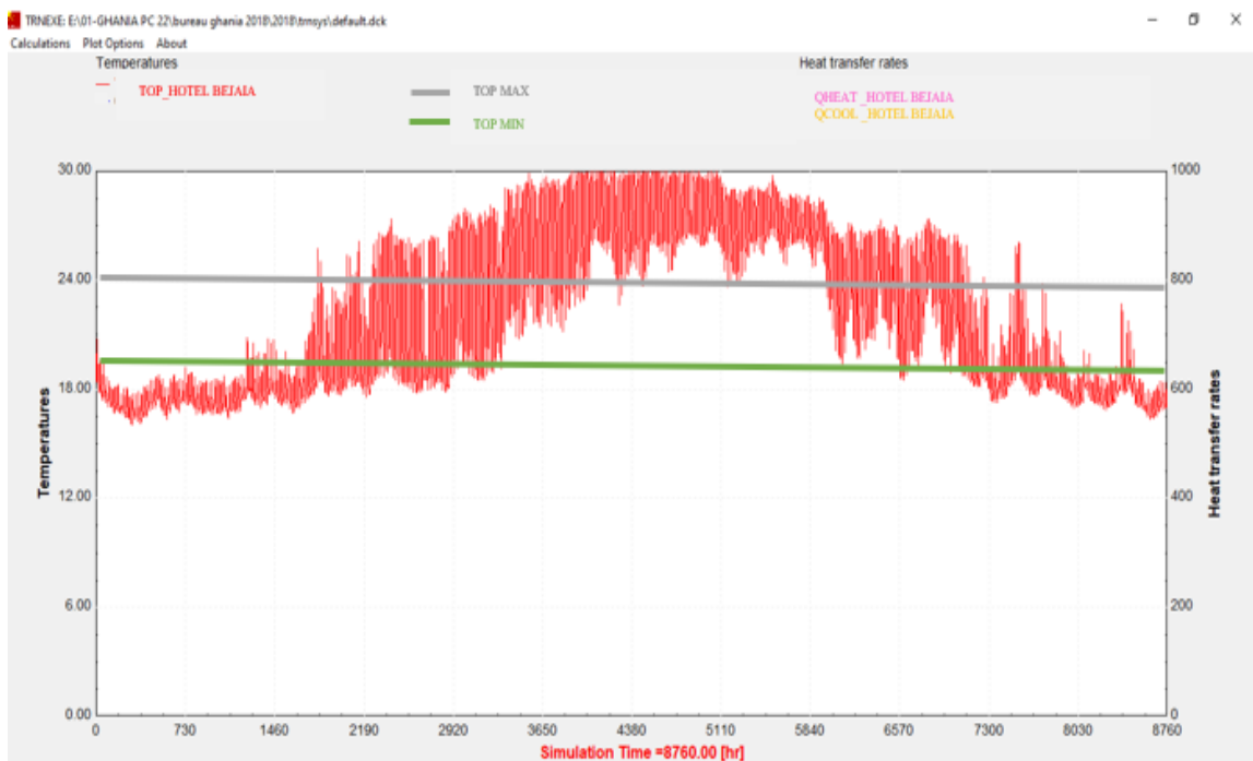
Figure 6.29 : Variation de la température opérative pour le cas optimisé (hôtel de Bejaia).
