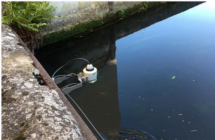
Figure 1.5 : Capteur de niveau radar VEGAPULS C21
