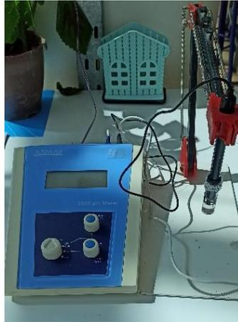
**Figure II.2 :** pH mètre-thermomètre
