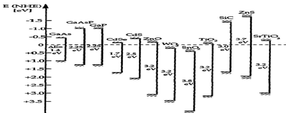
**Figure I.5 :** Potentiels et largeurs de bande de quelques semi-conducteurs en contact avec un électrolyte à pH=1
