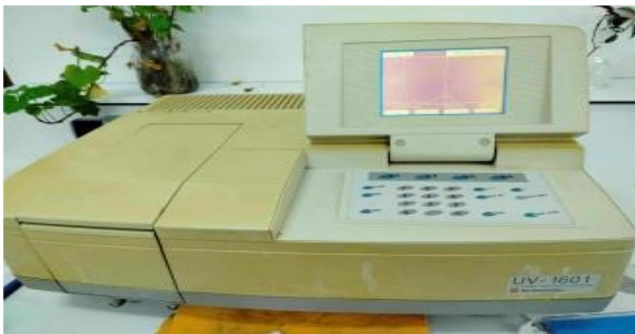
**Figure 2.9 :** Spectroscopie UV-Visible de de type 1601 et de marque SHIMADZU.
