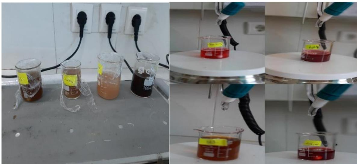
**Figure 2.10** : Détermination des fonctions de surface de la poudre de la caroube.
