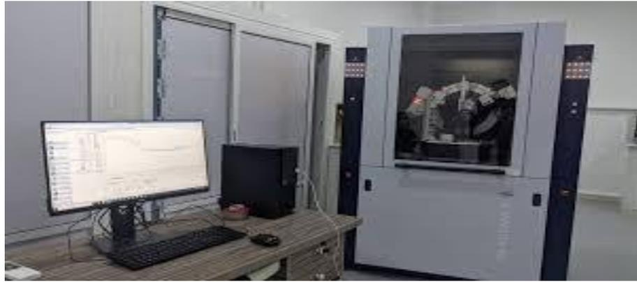
**Figure 3.18** : Diffractomètre de RX.
