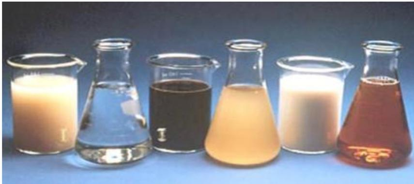
**Figure 2.1 :** Adjuvants liquides de gauche à droite : agent anti-lessivage, réducteur de retrait, réducteur d'eau, agent moussant, inhibiteur de corrosion et agent entraîneur d'air <sup>11</sup> .
