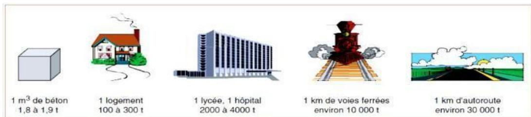
**Figure 1.3** : Consommation de granulats pour quelques ouvrages types <sup>5</sup>.
