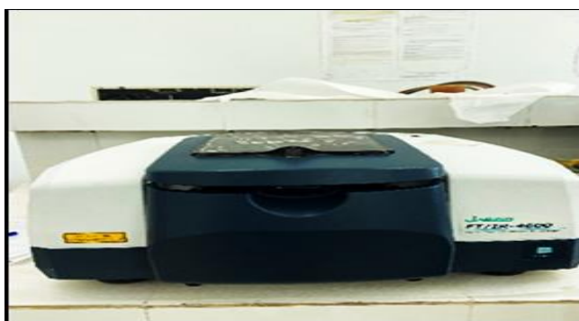
Figure2.9 : Appareil de FTIR (modèle JASCO 4000).
