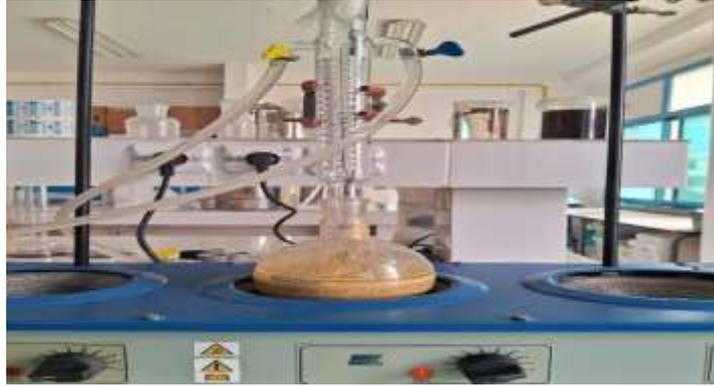
**Figure 40:** Montage extraction à reflux.
