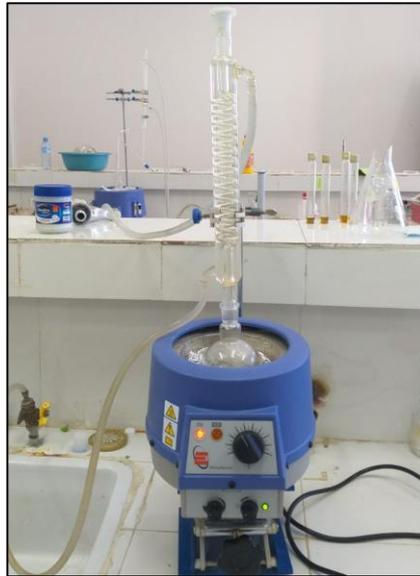
Figure IV.14: Montage chauffage à reflux.
