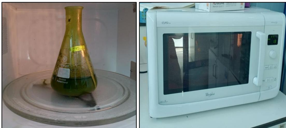
**Figure IV.11: Extraction par micro-onde.**
