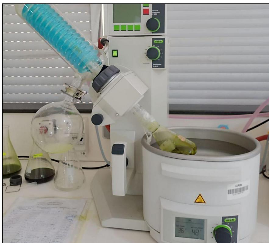
**Figure IV.12: Évaporateur rotatif.**
