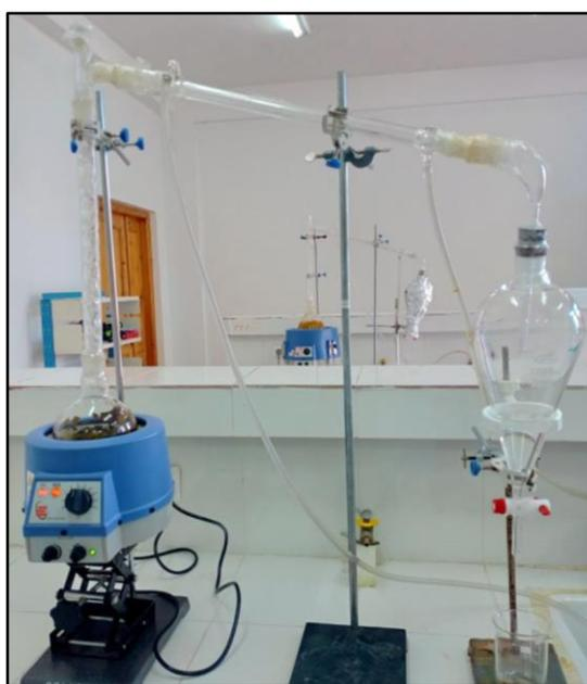
**Figure IV.7: Montage d'hydrodistillation type classique.**
