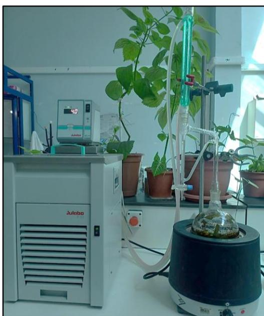
**Figure IV.8: Montage d'hydrodistillation type cleverger.**
