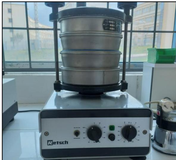
Figure IV.6: Tamiseur vibrant.
