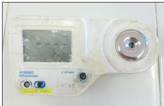
**Figure IV.13: Refractomètre HB96801.**
