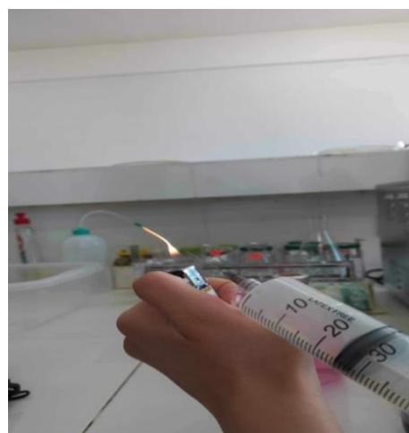
Figure III.6 : test d'inflammabilité de biogaz.
