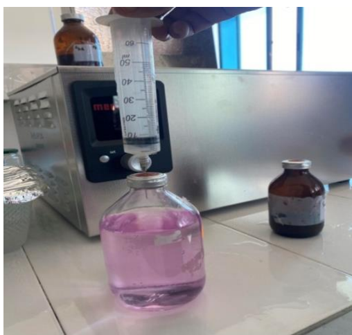
Figure III.5 : Détermination de la composition du biogaz par la solution de KOH.
