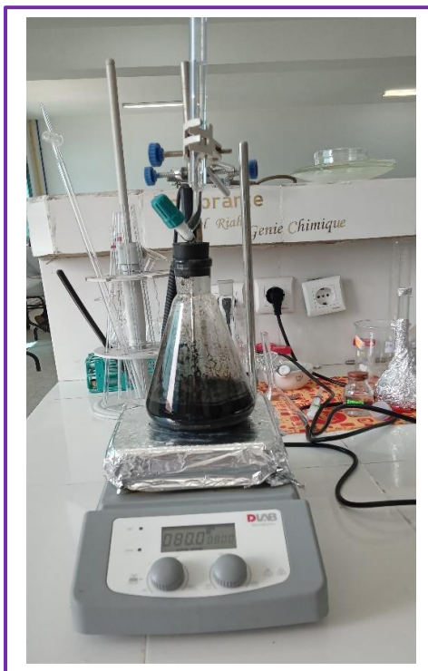
Figure II.16: Magnétisation du charbon actif commercial par précipitation en milieu basique (NaOH).
