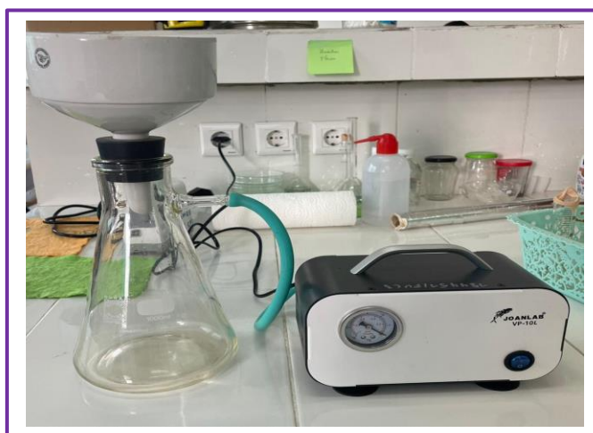
Figure II.17: Filtration du charbon actif magnétique (CAM).
