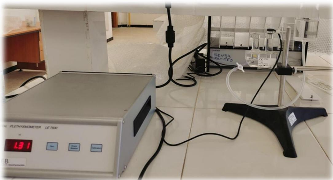
**Figure 54 :** Pléthysmomètre. (BIOSEB)
