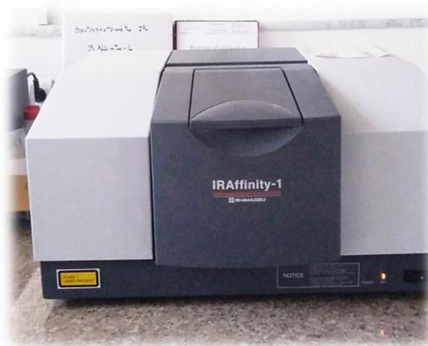
**Figure 52 :** Spectrophotomètre IR.
