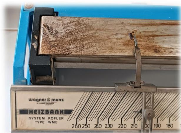
**Figure 137 :** Point de fusion de l'acide pipérique hémisynthétique.
