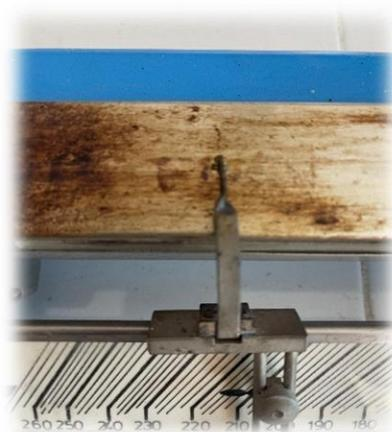
**Figure 147 :** Détermination du point de fusion de l'analogue 08 sur Banc Kofler.
