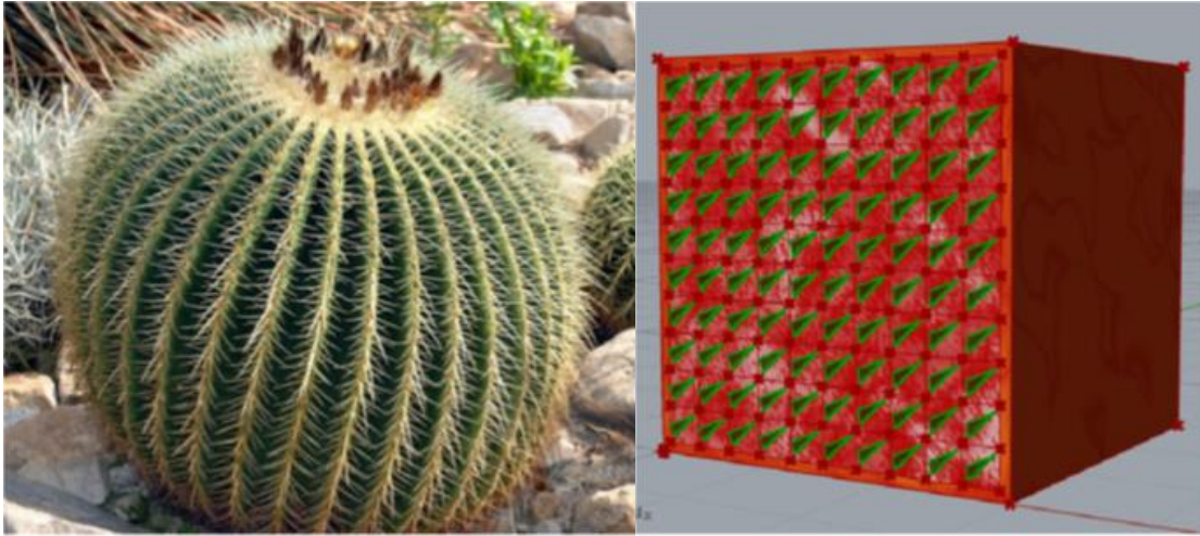
Figure 3.15 : L'étude s'inspire du cactus tonneau pour optimiser l'enveloppe du bâtiment. La configuration optimale présente un réseau d'unités orientées à 43° avec une inclinaison de 69°. Source : (Mansour, 2020)
