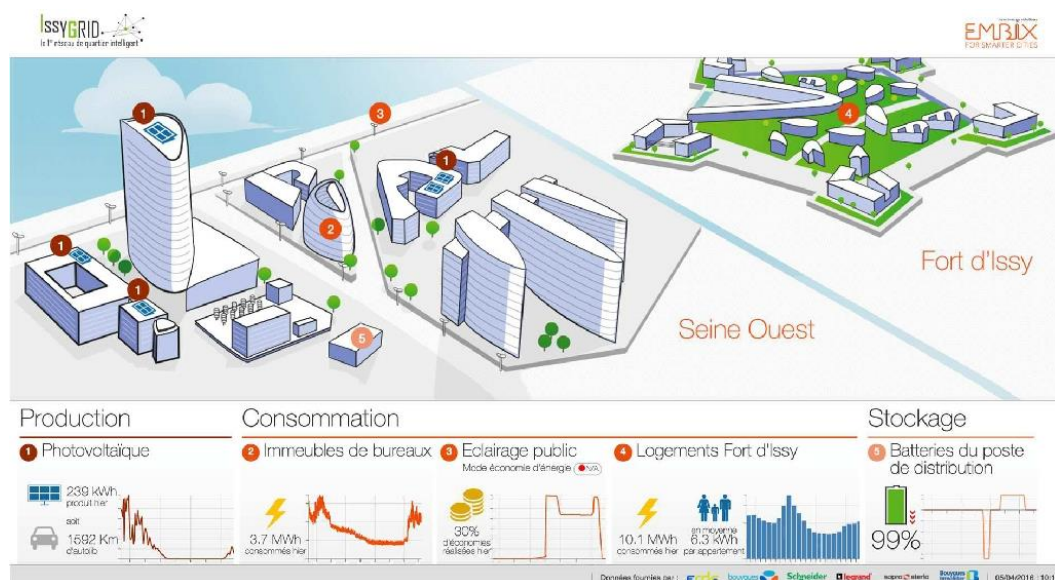
Figure 6.5 : Le projet de IssyGrid (Issy-les-Moulineaux -France)
