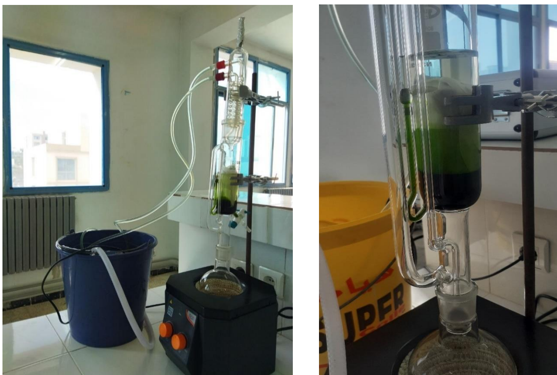
Figure II.3 : Montage d'extraction par Soxhlet.
