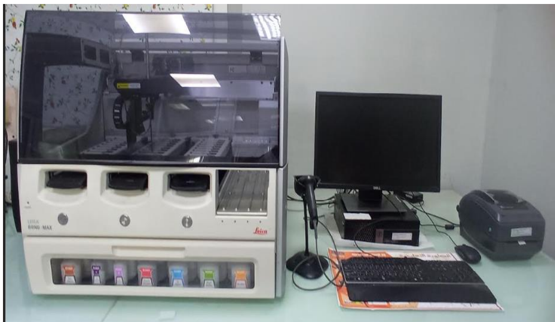
Figure7: Automate BOND MAX utilisé dans l'examen immunohistochimique à l'anticorps P16 au CHU de Constantine.
