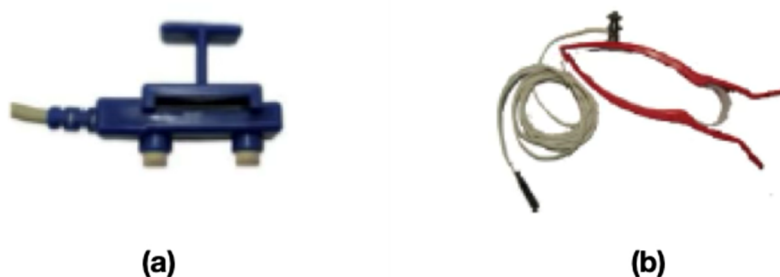
Figure 21 : Electrode de stimulation bipolaire avec distance de stimulation de 25mm et câble blindé (a), pince de terre EMG avec son câble connecteur (b)
