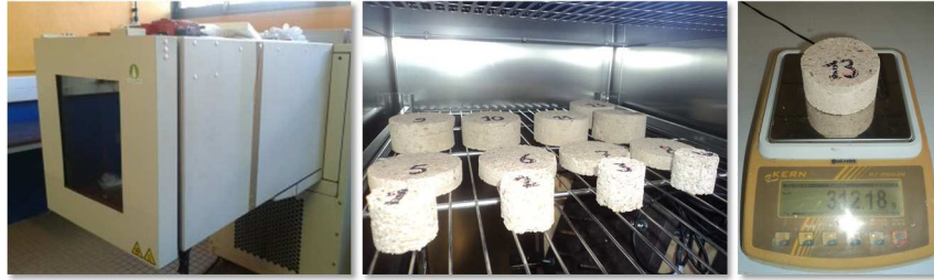
Figure IV-3 : Enceinte climatique et pesée des échantillons
