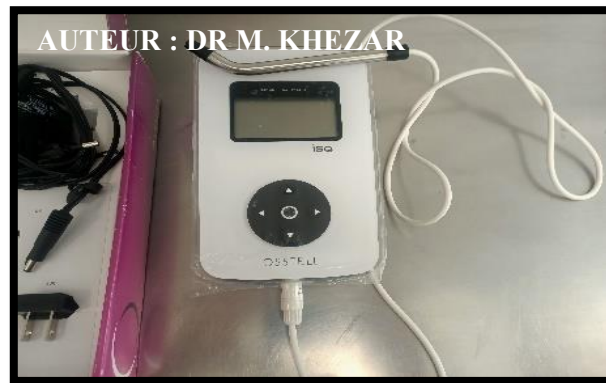
Figure 62 : Osstell pour mesure de la stabilité implantaire
