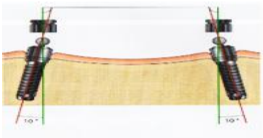
Figure 24 : Orientation des axes du système de connexion par rapport au plan d'occlusion
