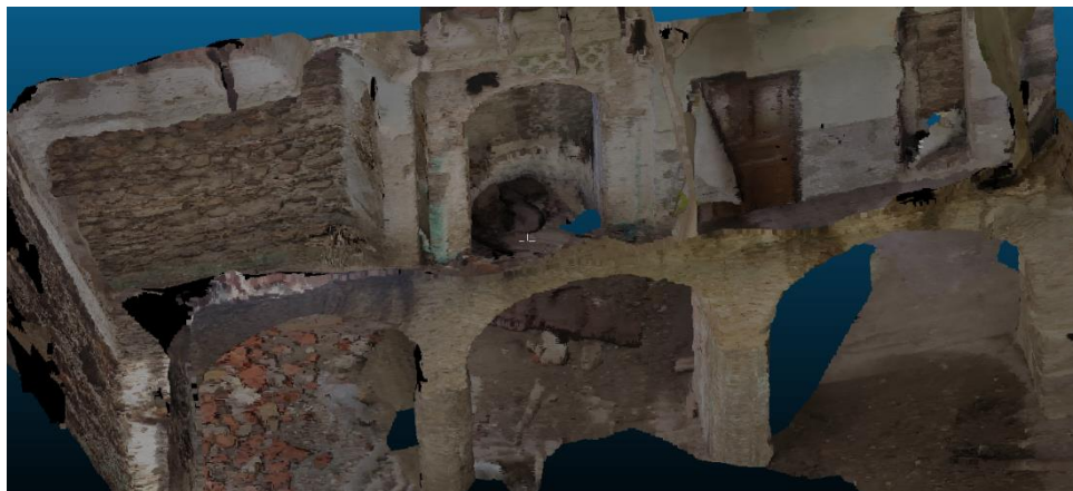
Figure 7.9. Résultat des points de densification de la salle de prière sous différents angles traités avec Cloud Compare. Source : Auteure
