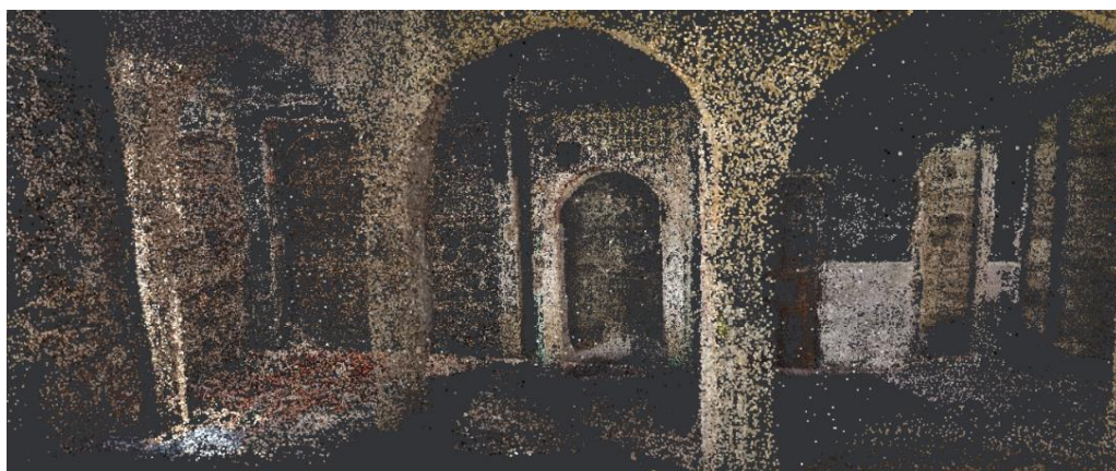
Figure 7.10. Résultat des points de densification de la salle de prière sous différents angles traités avec Meshroom. Source : Auteure
