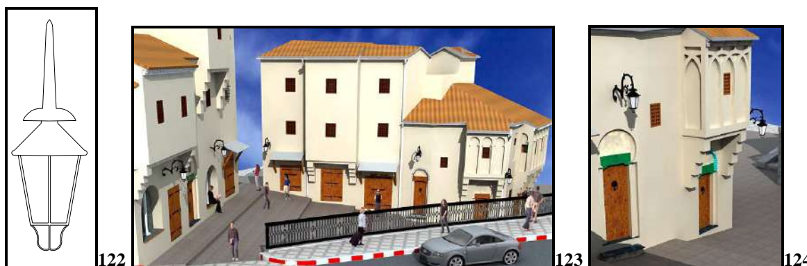
Figure 122 : Détail de lanterne proposée, figure 123 : et 124 : Vues en 3D d'emplacement des lanternes sur maisons. Dessin BET.
