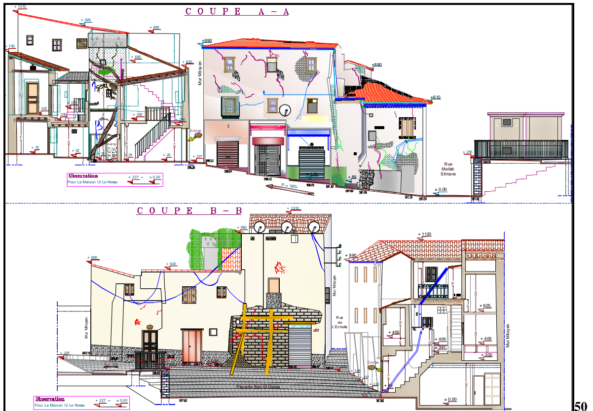
Figure 50: Coupes d'assemblage des lieux maison n°12 et 12 bis et 19 , 19 bis de Bab El Djabia. Relevées par l'Auteur. Dessin Autocad le BET.
