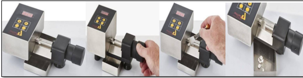
Figure 10: : Différentes étapes de réalisation du test de la dureté par un duromètre.[60]
