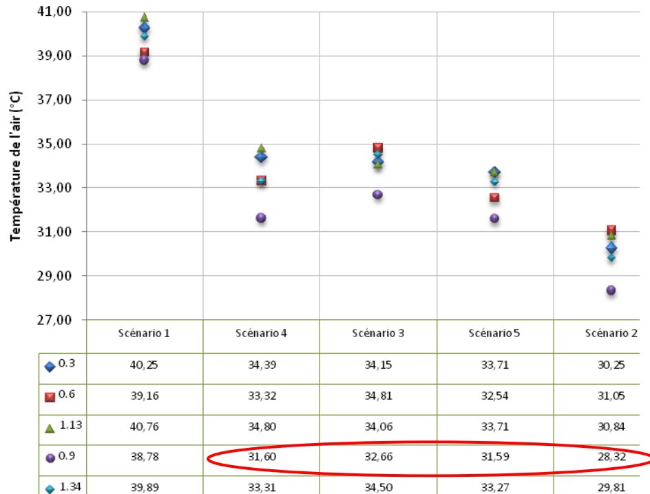
Figure VI.52: Température de l'air simulée et le ratio H/L selon les différents scénarios
