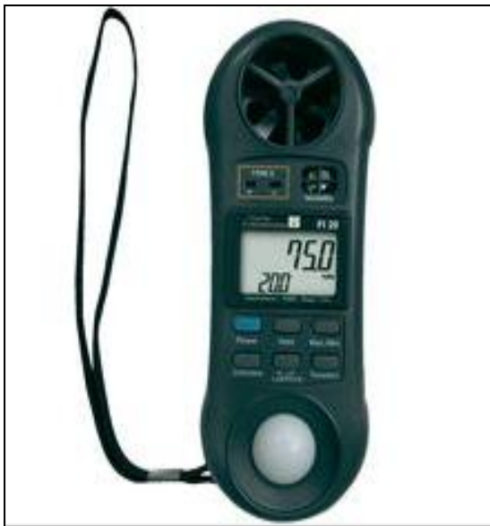
Figure IV.4: Instrument portable (LM800) à quatre fonctions. (Anémomètre, hygromètre, thermomètre et luxmètre)
