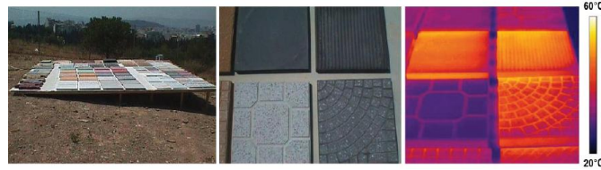
Figure I.37 : Photo et thermographies IRT des revêtements testés dans l'étude de [Doulos et al. 2004] 99
