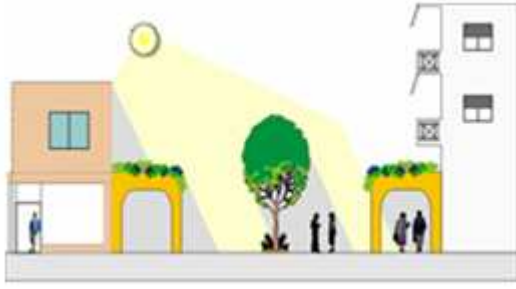
Figure n° 57 des arcades pour se protéger du soleil et du vent Source : CHRISOMALLIDOU, N. 2004
